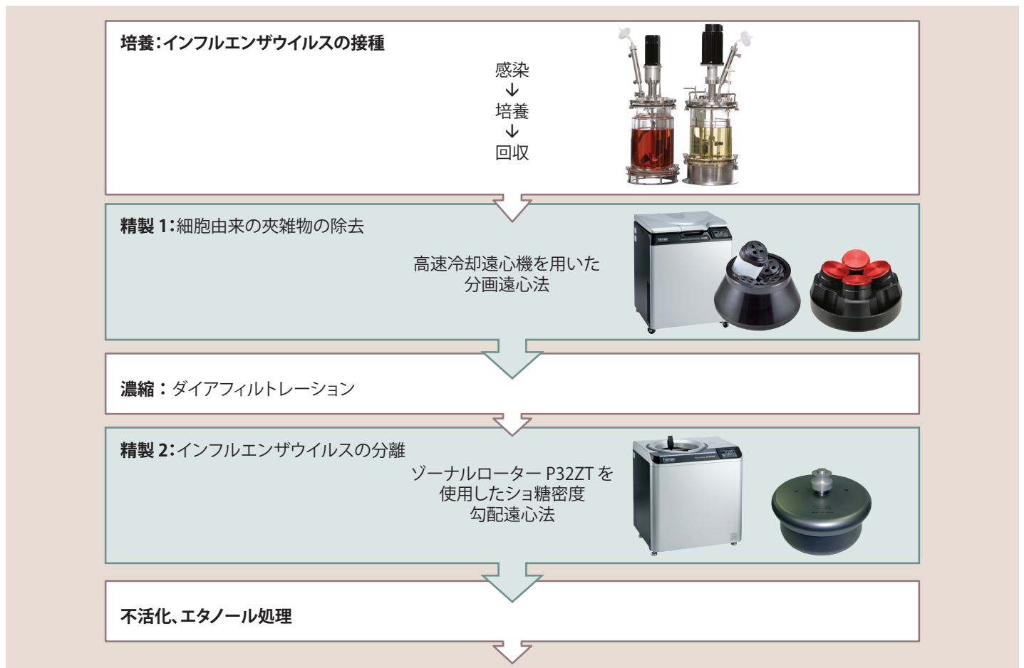
図 6：培養細胞インフルエンザワクチンの製造プロセスの一般的なワークフロー。
